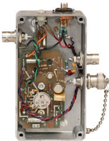
Сл. 2.2 Конверзија појачивачког чипа мале улазне импедансе и велике брзине у чип веома високе улазне импедансе за детекцију сигнала са фотомултипликатора, развијеног у Националном институту за стандарде и технологије САД 1990. године
