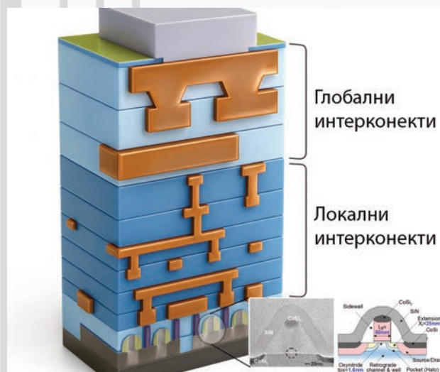
Сл. 7.1 Интерконекти од 9 слојева који се састоје од изолатора силицијум-диоксида и материјала за заустављање плазма нагризања – (данас се користи и до 20 слојева). У доњој равни су FET транзистори, а резолуцију одређују вертикалне конекције.
