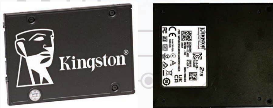
Слика 6.2 данас актуелна флеш меморија за екстерне SSD – дискове за чување података од 2 TB. Капацитет ове меморије је грубо процењено на око 300.000 књига, форматираних као енциклопедија са око 1000 страница.
