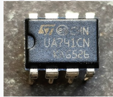
Сл. 2.1 Fairchild операционо појачало \mu A741 : а) симбол и изглед чипа; б) електронска шема Извор: https://upload.wikimedia.org
