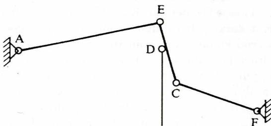
Slika 1a. Vatovo "paralelno kretanje" u prvobitnom obliku.  $AE$  je greda.  $D$  je kraj klipnjače. Trouglovi označavaju fiksirane tačke.
